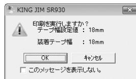
「テープ幅設定値」と「装着テープ幅」が異なっていると、正確な印刷結果が得られません。そのときは [キャンセル] をクリックして [テープ幅設定値] と [装着テープ幅] が揃うように設定してください。
