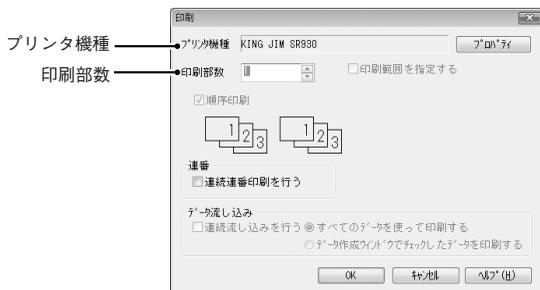
**プリンタ機種** : プリンタ機種が接続している「テブラ」PRO本体であることを確認します。違う「テブラ」PRO本体が選択されているときは、[キャンセル] をクリックして印刷を中止し、[テープ設定] 画面で機種を選択しなおしてください。
